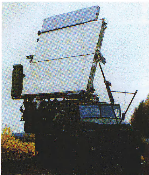
Рис. 4. Радиолокационная станция 64ЛЕ («Гамма-С1Е»)
