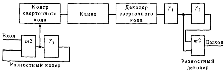
Рис. 9.31. Схема СПИ при использовании прозрачных сверточных кодов
