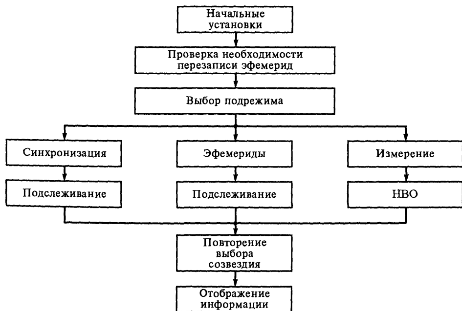
Рис. 8.10. Алгоритм управления подрежимами в АП
