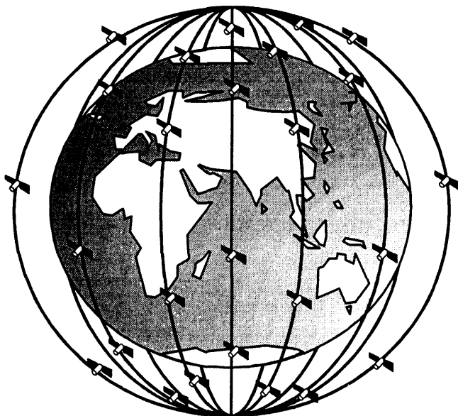
Рис. 9.59. Схема орбитальной группировки системы Iridium
